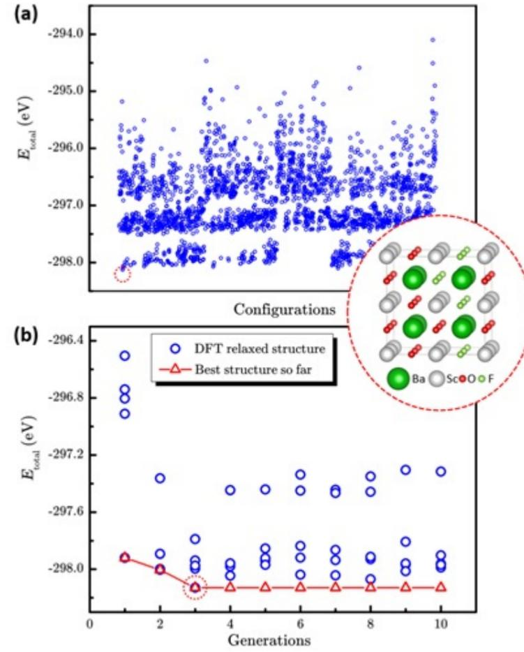
图2 传统枚举法和LAsou法在 $\text{BaSc}(\text{O}_x\text{F}_{1-x})_3$  ( $x=0.667$ )体系预测的表现。(a) 2664个枚举结构和最稳定结构的总能量散点图。(蓝色圆圈代表每个结构的能量, 红色虚线圆圈代表能量最低的结构。)(b) LAsou方法搜索过程中总能量随搜索代数的演化。(红色三角代表历史上搜索的最低能量结构。)
