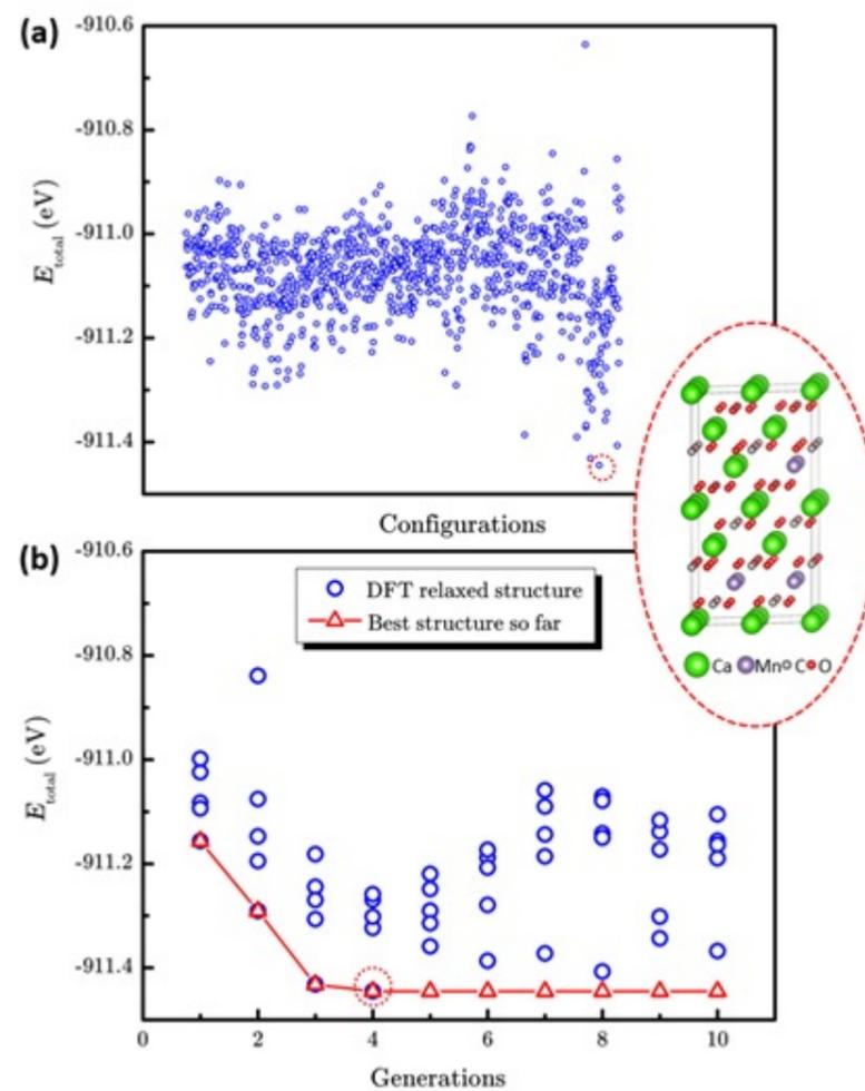
图3 传统枚举法和LASou法在 $\text{Ca}_{1-x}\text{Mn}_x\text{CO}_3$  ( $x=0.25$ )体系预测的表现。(a) 1033个枚举结构和最稳定结构的总能量散点图。(b) LASou方法搜索过程中总能量随搜索代数的演化。
