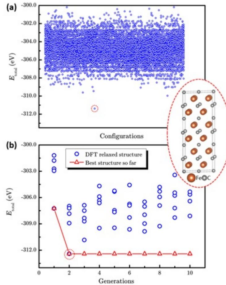
图4 传统枚举法和LAsou法在 $\epsilon$ -FeC<sub>x</sub> (x=0.5)体系预测的表现。(a) 10496个枚举结构和最稳定结构的总能量散点图。(b) LAsou方法搜索过程中总能量随搜索代数的演化。
