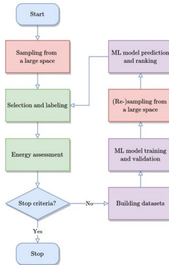
图1 基于主动学习的LAsou方法进行材料结构预测的流程图
