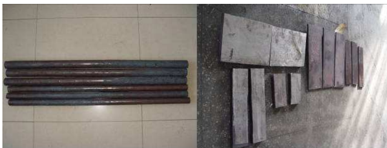
图2 由吨级CLAM钢铸锭加工出的实验用型材
