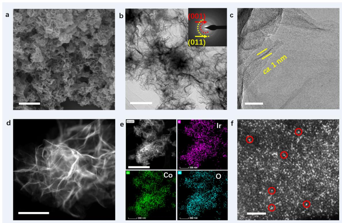
图1. 催化剂的结构表征。(a-c) CoO<sub>x</sub> NSs基底。其中内嵌图标示了选区衍射的扩散带。(d-f) Ir-CoO<sub>x</sub> NSs的结构表征。红圈标示出了Ir单原子。Ir/Co比例约为7:93，Ir原子载量约为20%的质量分数。
