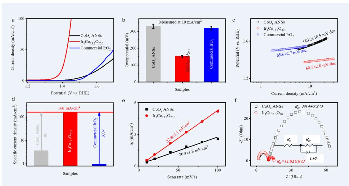
图2. 电化学测试结果。OER极化曲线 (a) , (b-c) OER性能比较, 双电层电容测试 (e) 和传质效率分析 (f) 。
