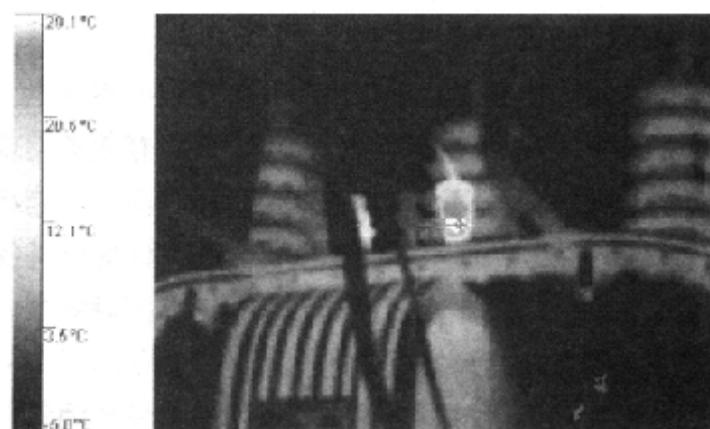
图3 10 kV配电变压器低压套管接头过热图谱
