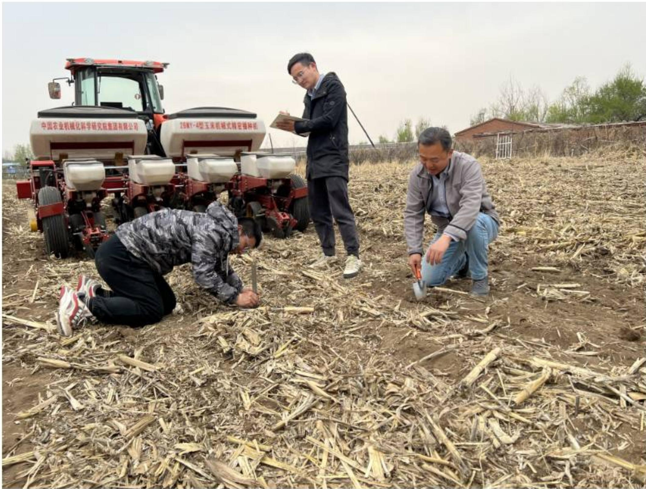
团队采用科学设计方法，依据相关标准与作业规范，设计了详细的高速免耕精量播种试验方案，开展了20余种工况试验，测试了详实试验数据，数据量达10000余个，深入探究复杂作业环境下播种机械-土壤-秸秆-种子间的互作关系，分析黑土地高速免耕条件下存在的实际问题，提出下一步研发方案。
