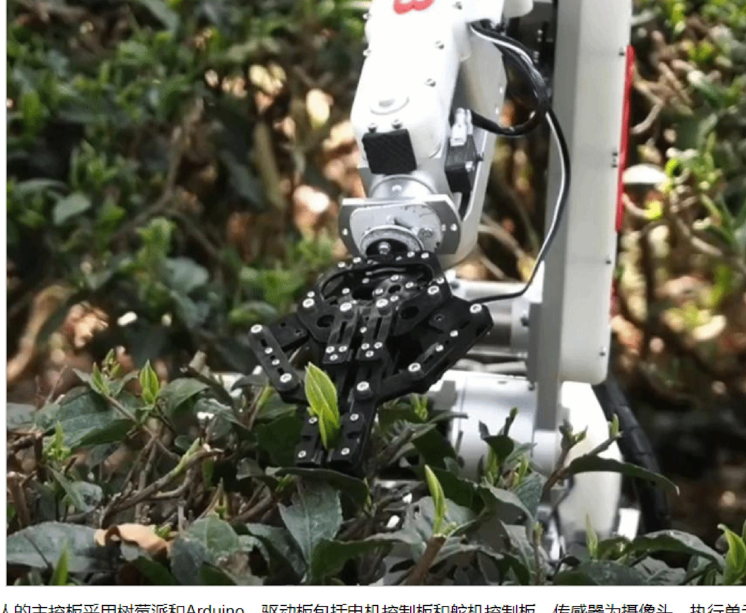
该机器人的主控板采用树莓派和Arduino，驱动板包括电机控制板和舵机控制板，传感器为摄像头，执行单元包括电机和大扭力舵机。在采茶过程中，机器人采用PID闭环控制方法，通过传感器采集环境信息并传递给树莓派，判断是否有一芽两叶并进行定位。如果没有一芽两叶，则驱动电机再次寻找。如果有一芽两叶，则传感器舵机进行定位并向Arduino发送信号。通过Arduino控制的舵机控制板驱动机械臂完成采茶，从而实现闭环控制。教育部科技查新工作站N12在2023年4月3日《基于改进型YOLOv5神经网络的山地自主采茶机器人》科技查新报告结果显示，经过查新机构对查新项目进行国内外对比分析，证明该机器人的智能识别程序研究仅见于委托人（王白娟教授）课题组的文献报道，未见采茶机器人的位移驱动模块文献报道。
