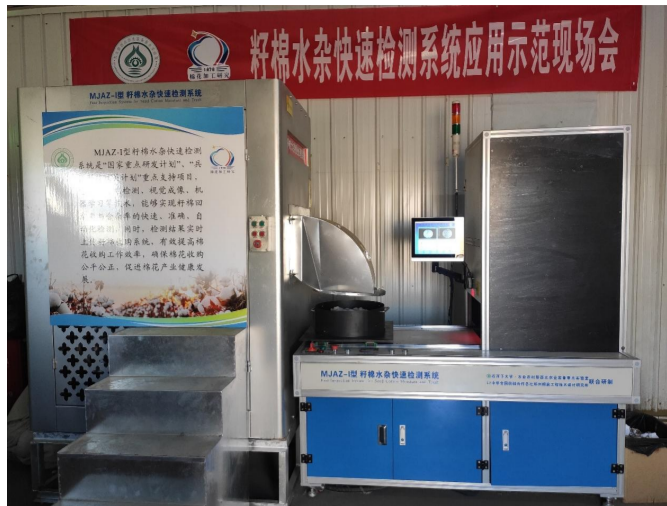
图3 籽棉收购水杂一体化智能检测系统样机
