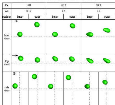
不同雷诺数下液滴的平衡位置和变形情况。
