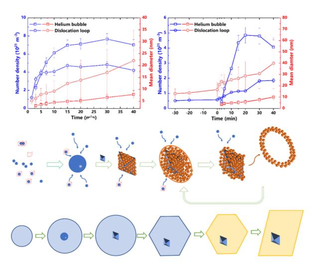
通过原位TEM揭示了双束离子辐照镍基合金中氦泡和位错环的协同演化机制,包括位氦泡挤压 位错环形成及发射机制和菱形位错环形成机制。
