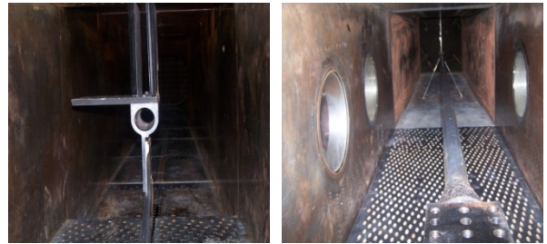
图4 模拟装置安装在 0.6 米跨声速风洞试验段
