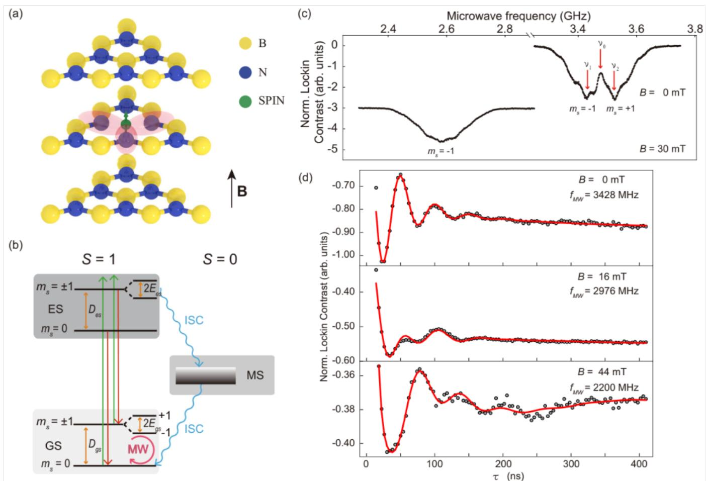
图1：(a)VB-色心的原子结构示意图；(b)VB-色心的电子自旋能级结构；(c)不同磁场下VB-色心的ODMR信号；(d)不同磁场下VB-色心的Rabi振荡信号。
