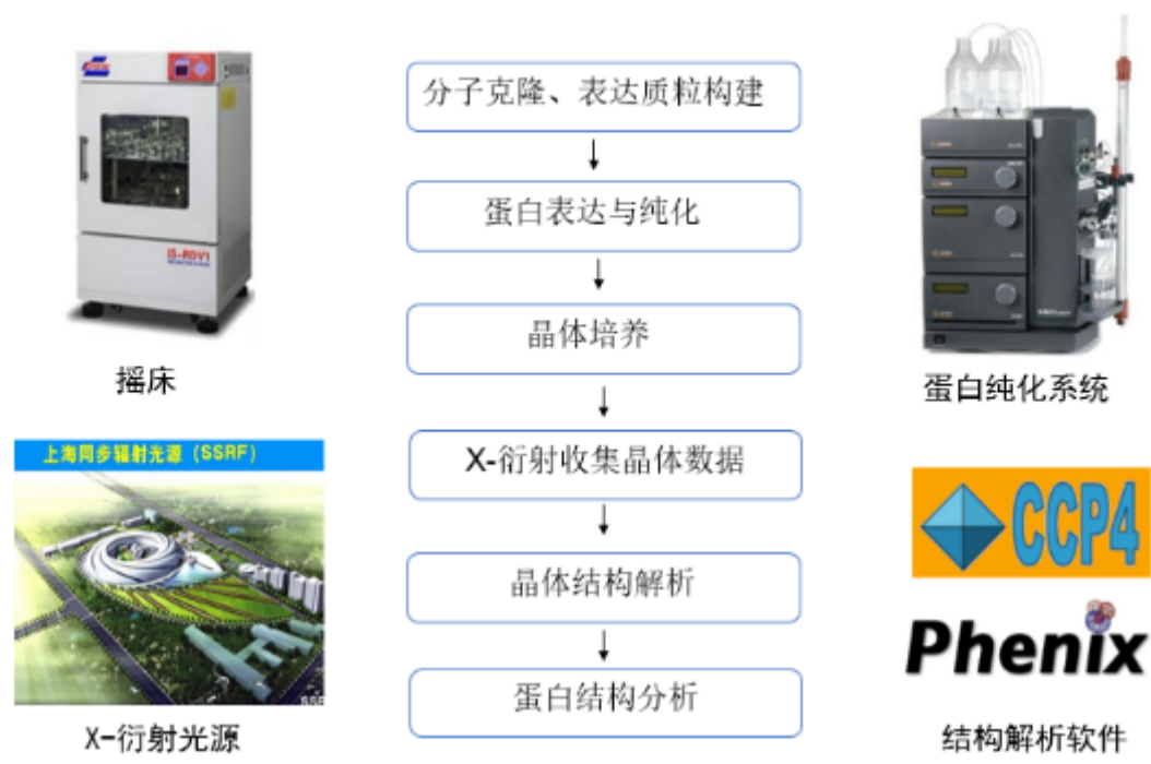
图3. 蛋白质结晶与X-衍射结构解析技术路线
