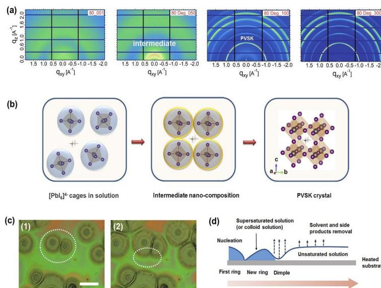
(a) 印刷钙钛矿从前驱液到多晶薄膜转换过程中不同阶段的GIXD二维衍射图；(b) 钙钛矿结晶的纳米中间体组装模型；(c) 印刷薄膜的形貌显微镜图；(d) 周期性“结晶-耗尽”物理模型示意图。
