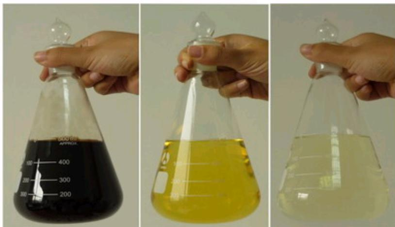
图二：左：粗油；中：粗油经脱色精馏处理制备的柴油；
