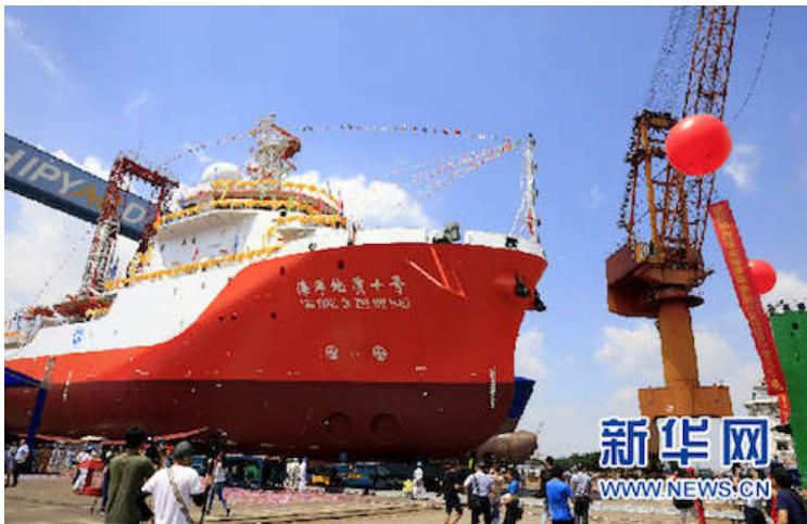
6月28日，我国自主设计、建造的“海洋地质十号”综合地质调查船在广东东莞出坞下水，该船填补了我国小吨位大钻深海洋地质钻探船的空白，提升了海洋地质调查能力，也标志着我国海洋地质综合调查能力跻身世界前列。“海洋地质十号”是集海洋地质、地球物理、水文环境等多功能调查手段为一体的综合地质调查船。船身总长75.8米、宽15.4米、深7.6米，结构吃水5.2米，排水量约3400吨，续航力8000海里，定员58人。新华社发（黄国保 摄）
