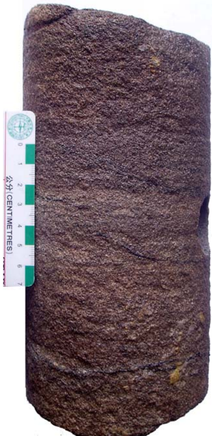
A: 2997.50 ~ 2997.75 m, 层位: J 1 s 描述: 灰色中层状长石粗砂岩, 发育槽状交错层理, 局部见炭屑纹层 特殊现象: 槽状交错层理
