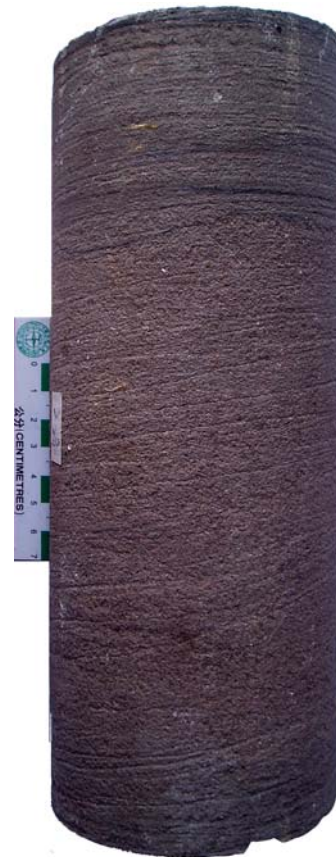
C: 2994.70 ~ 2995.12m, 层位: J 1 s 描述: 青灰色薄层状岩屑中细砂岩, 下部发育槽状交错层理, 上部发育波状交错层理 特殊现象: 槽状交错层理, 波状交错层理
