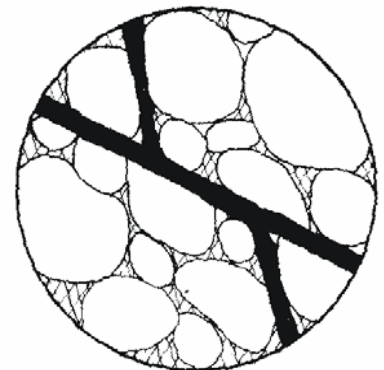
f. 裂缝孔隙 Fracture
