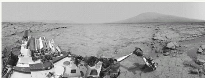
好奇号探测器在前往5000米高的夏普峰的路途中,首次在此地点钻入火星岩石进行取样。更多的钻探和检测发现了火星上有机物质存在的痕迹。图片来源: NASA/JPL-CALTECH
