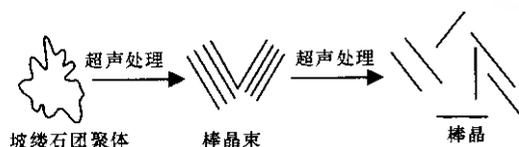
图 2 超声分散制备坡缕石纳米级微粒子
