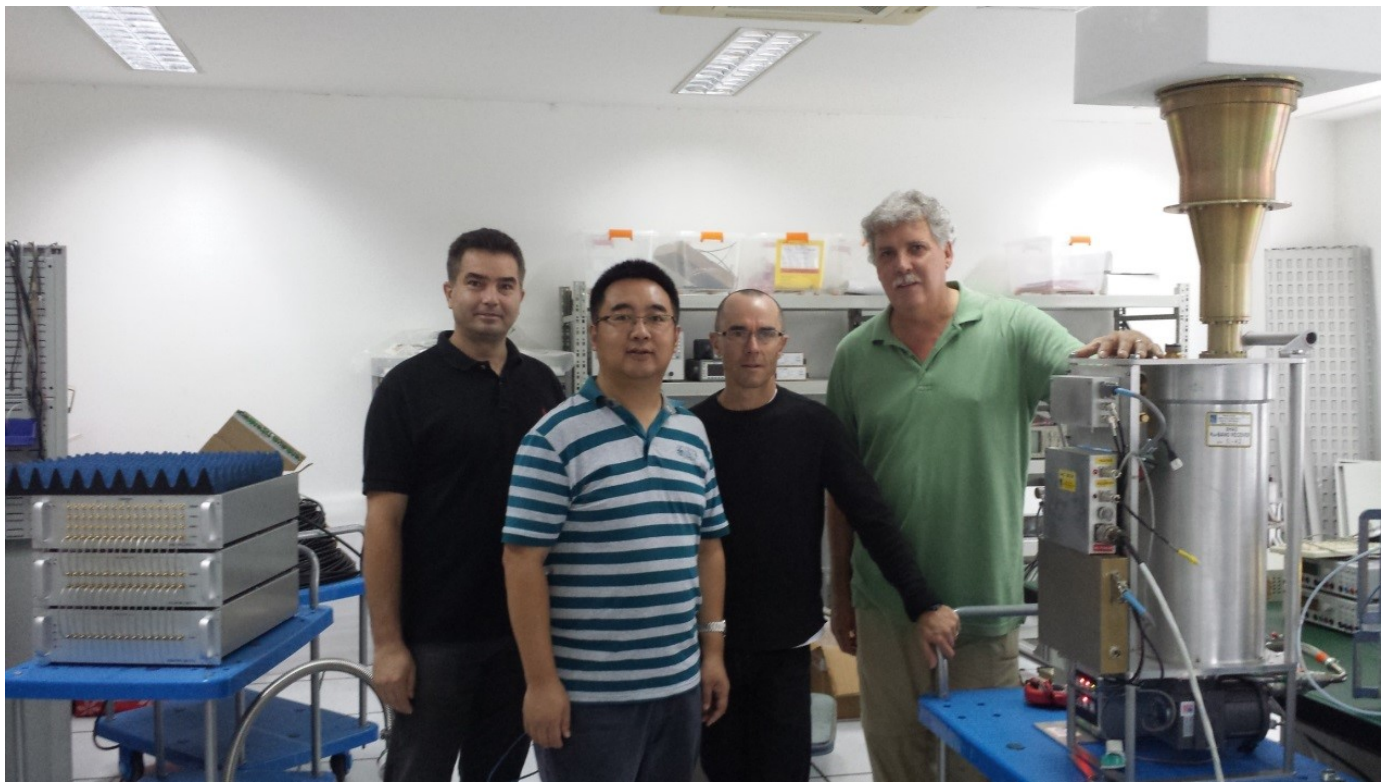
在佘山25米接收机实验室进行设备组装和性能测试。正在进行的是冷热微波负载测量接收机等效噪声温度，泡沫盒内装有液氮浸泡的微波黑体材料。
