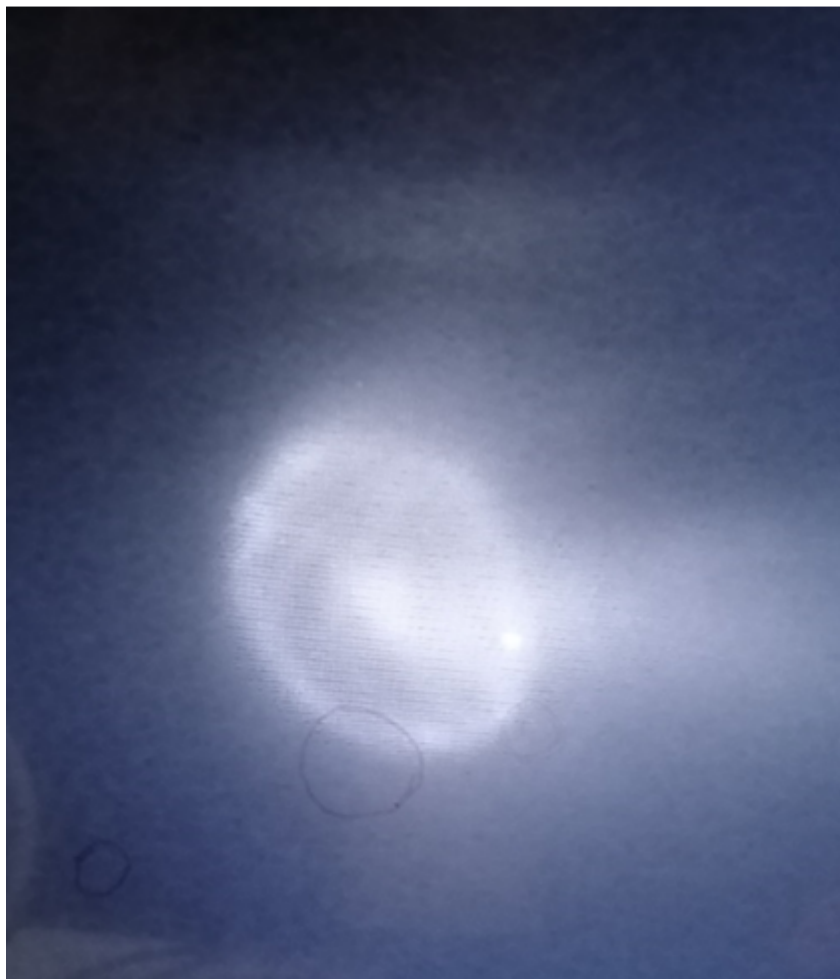
图1: 离子源强流在法拉第筒上的束斑
