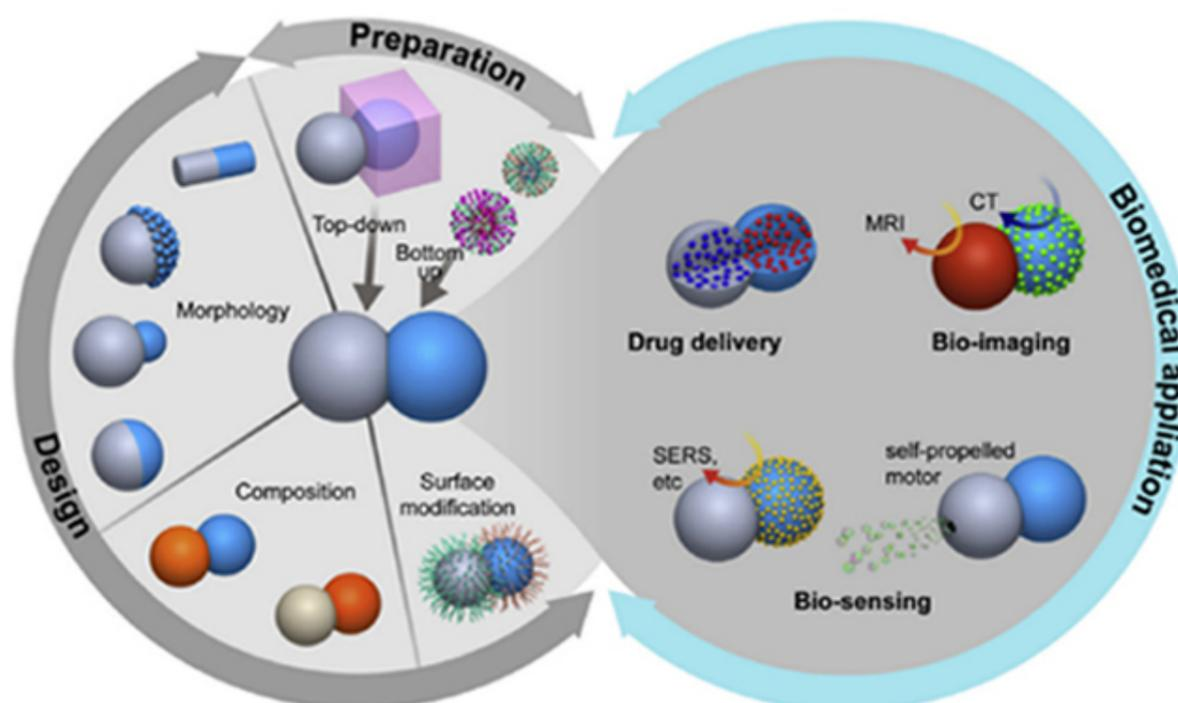
两面神粒子是由物理和化学性质不同(通常性质相反)的两个或多个组分构成的具有精细结构的粒子。两面神粒子的不同组分具有不同的表面亲/疏水性、磁性、光学特性、电学特性等, 具有多功能、易修饰等优点; 同时不同部分的特性有助于改善整体的化学和物理特性, 以满足特定的应用需求。因此, 近年来两面神粒子在催化、电化学、生物医学等领域显示出了广阔的应用潜力。两个团队根据多年来设计制备和应用两面神粒子的研究和经验, 提出了粒子的设计策略, 能够很好地控制两面神粒子的形貌、粒度、组成和表面改性; 介绍了两面神粒子的常用合成方法, 重点描述了表面成核法和种子生长法; 探讨了两面神粒子在药物传递、生物成像、生物传感等生物医学领域的应用; 最后, 对两面神粒子的设计、制备和生物医学应用进行了总结, 并介绍了两面神粒子在这些方面所面临的挑战。
