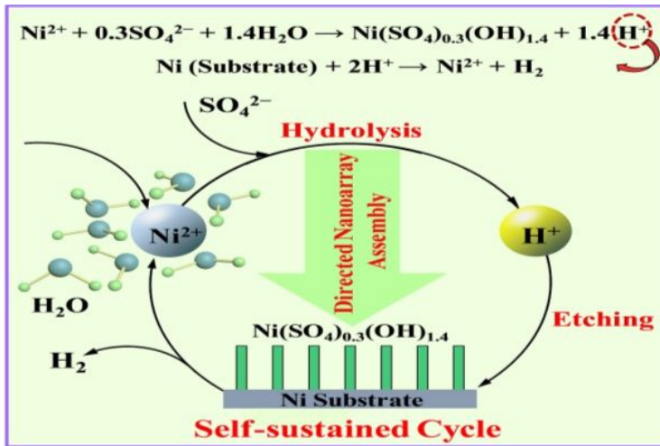
“水解-刻蚀自维持循环”生长方法机理示意图
