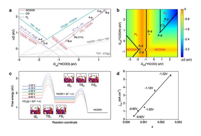
该团队基于密度泛函理论计算,首先建立了碱式碳酸铅催化剂模型。根据催化剂可能暴露的表面不同,以及表面是否含有阴离子空位缺陷,一共可得到6种可能的反应活性位点。计算发现,在碱式碳酸铅的不同位点上,反应中间产物的吸附能也存在很好的关联性。由此以\*HCOO的吸附能为描述符建立一维反应
