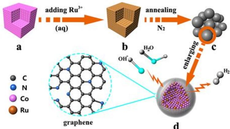
RuCo@NC纳米粒子的合成路径和结构模型示意图。(a)  $\text{Co}_3[\text{Co}(\text{CN})_6]_2$ , (b)  $\text{I}\text{Co}_3[\text{Co}(\text{CN})_6]_2$ , (c) RuCo@NC纳米粒子的聚集体示意图, (d) c中一个RuCo@NC纳米粒子的模型示意图，并简单描述了作为电催化剂在碱性介质中的析氢过程。
