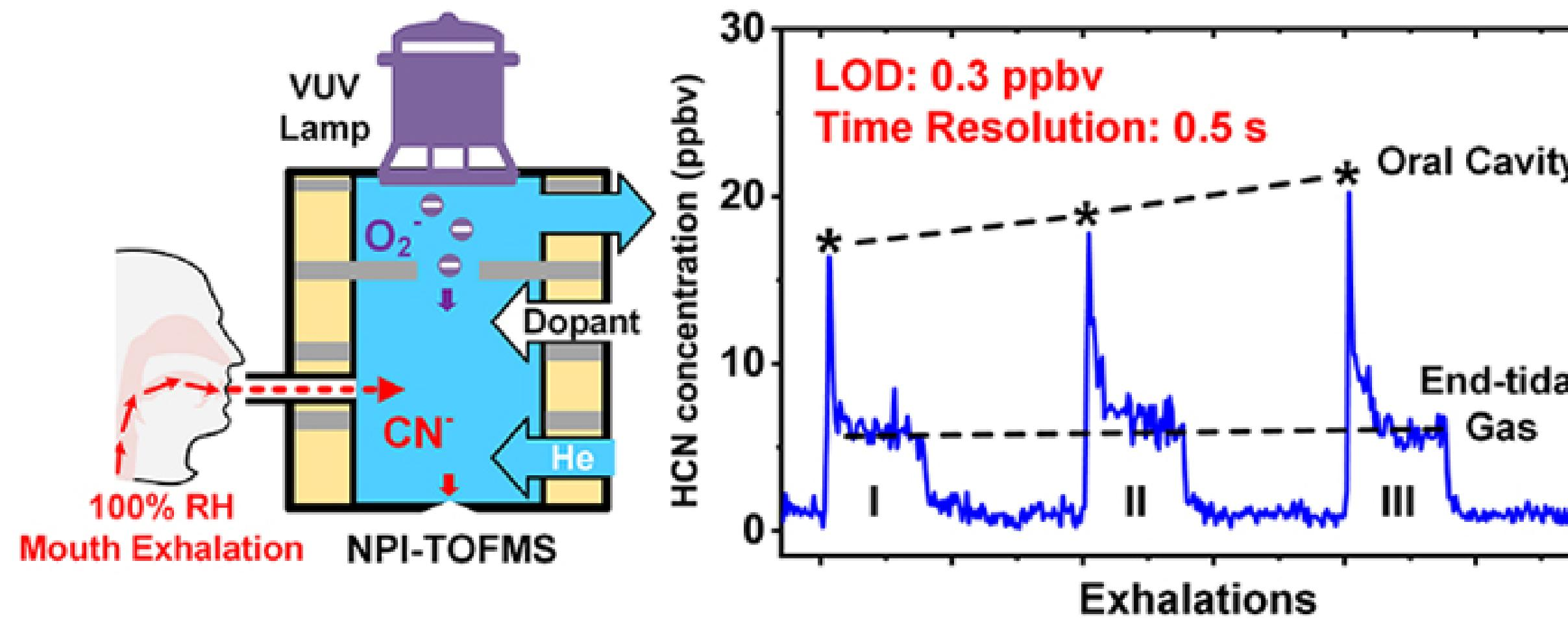
该团队在前期工作(*Anal. Chem.*, 2014; *Anal. Chem.*, 2016; *Anal. Chim. Acta*, 2020)的基础上, 本工作中提出在质谱电离源内, 采用氦气反吹方法, 降低高湿度样品气对电离的影响, 同时提高离子传输效率, 极大增强了HCN检测的灵敏度。团队在采样系统中进一步增加动态吹扫, 有效减小了HCN的吸附残留, 提升了该方法的时间分辨。该方法将HCN的检测灵敏度相对空气反吹条件提升了150倍, 检测限达到0.3 ppbv, 时间分辨达到0.5 s。团队将该技术用于跟踪监测志愿者漱口前后单次呼气中HCN轮廓变化, 可以区分出单次呼气中HCN显著的“尖峰”和“平台”区间, 分别反映了口腔和肺泡释放源的浓度水平, 表明了该方法的抗干扰能力和HCN定量的准确性。
