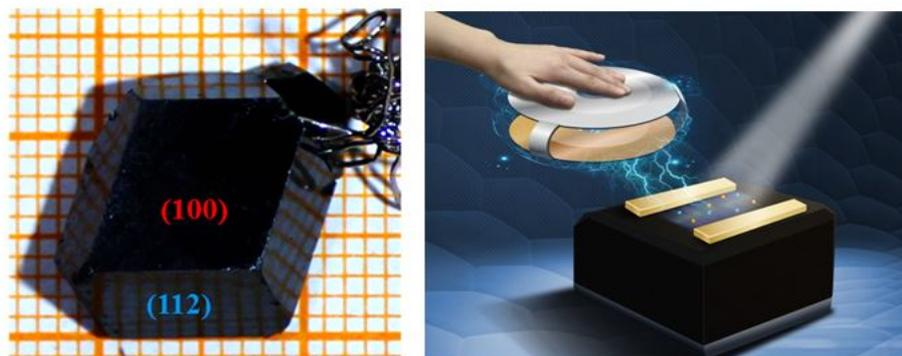
光探测器主要分为光生伏特型和光电阻型，光电阻型光探测器具有结构简单、材料选择范围宽、易于集成等优点，但需要外加偏压对其供电。为了解决这一问题，该课题组最近将摩擦电纳米发电与甲胺碘化铅单晶结合，制备了自供能的光电阻型光探测器，相关工作发表在Journal of Materials Chemistry C上 (2015, DOI: 10.1039/C5TC03342J) 并被选为背封面论文，论文第一作者为化学系博士生方华靖。具有优异性能的无机-有机杂化钙钛矿单晶的出现，有可能实现对多晶钙钛矿基光电子器件的革新，推动光电器件的进一步发展。该研究工作得到国家自然科学基金重大研究计划培育项目及低维量子物理国家重点实验室开放研究基金资助。
