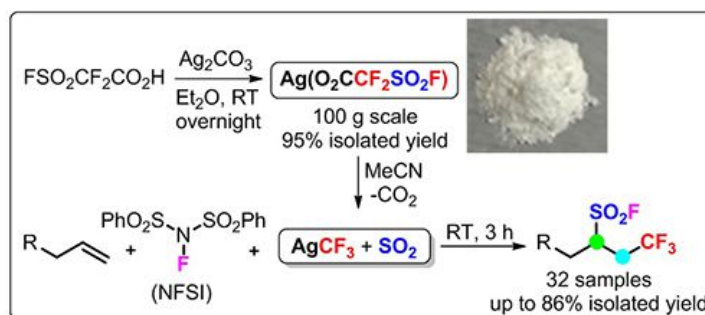
图三、 Ag(O_2CCF_2SO_2F) 试剂制备和对烯烃的氧化自由基三氟甲基化氟磺酰基化
