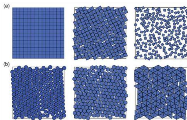
胶体颗粒自组装形成的形态举例。(a)横截面为正方形的颗粒在不同堆积密度下的形态。(b)不同横截面的颗粒在同一堆积密度下的形态。
