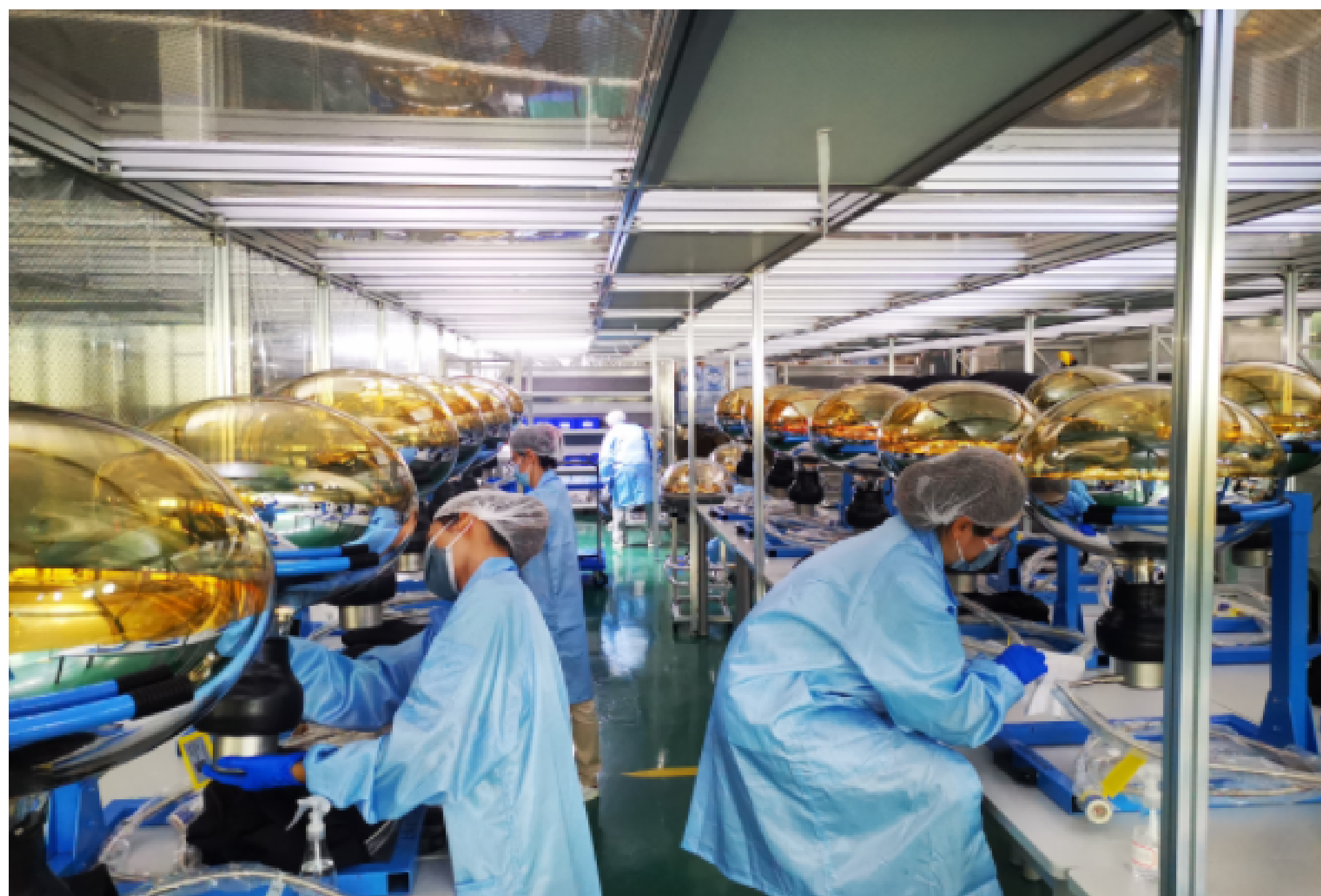
对装配前的PMT进行清洁处理
