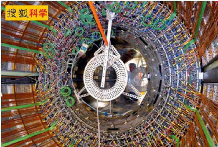
压缩介子线圈(CMS)实验的内层探测器
