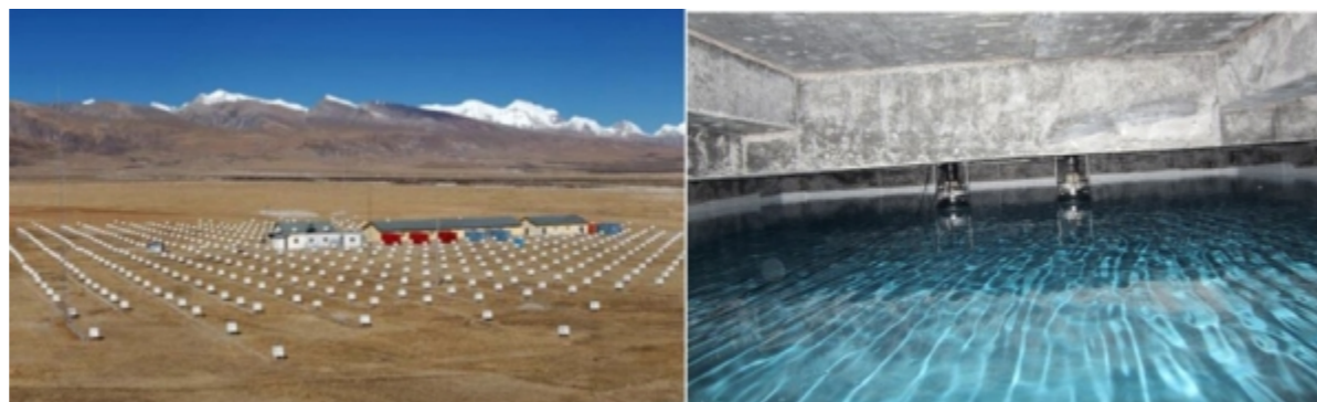
我国西藏羊八井ASy实验（左图：ASy表面阵列；右图：地下水切伦科夫探测器）
