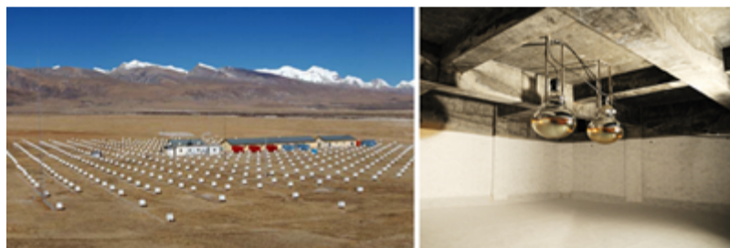
图2: 我国西藏羊八井AS \gamma 实验(左图: AS \gamma 表面阵列;右图: 地下水切伦科夫探测器)
