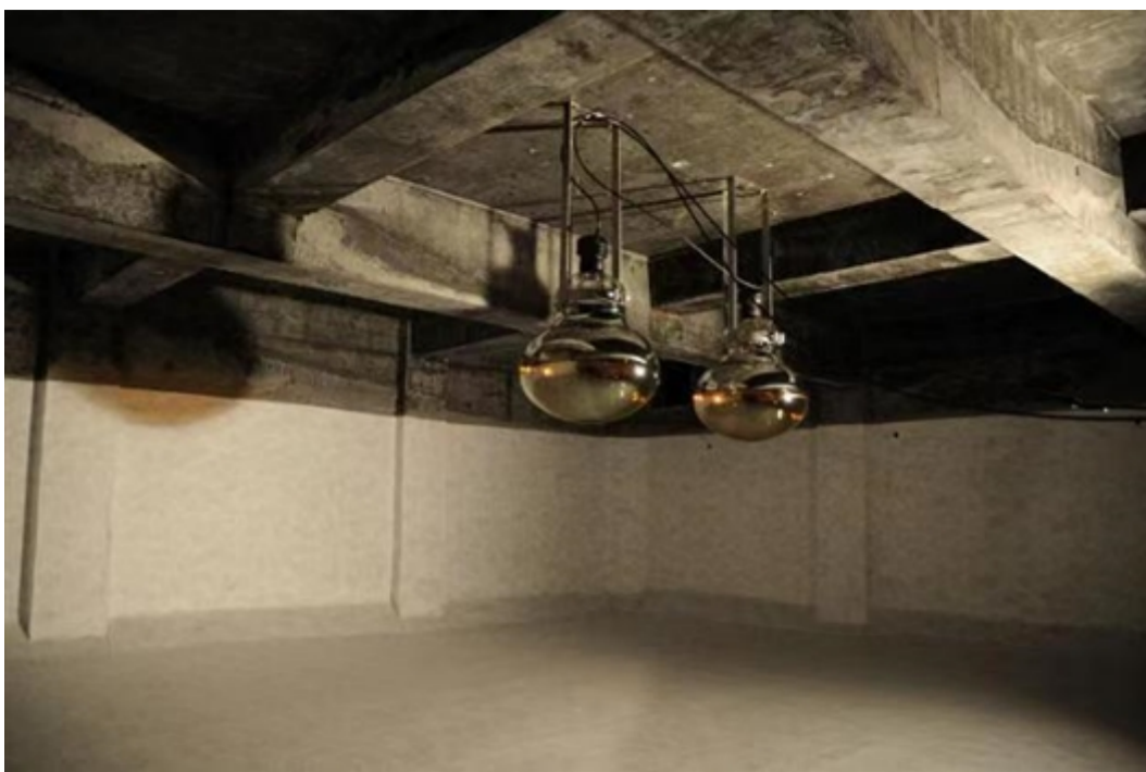
地下缪子水切伦科夫探测器（中科院高能所供图）
