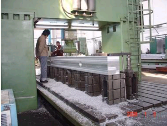
正在加工中的背梁
