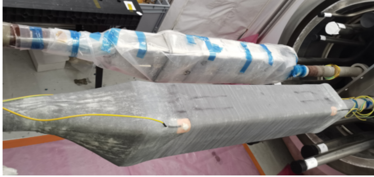
完成所有绝缘固化后的TF12超导接头
