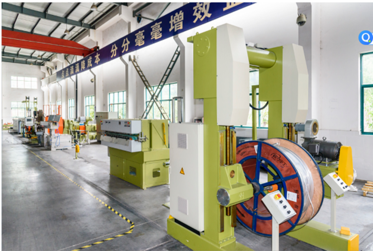
卢瑟福超导电缆连续覆铝生产线
