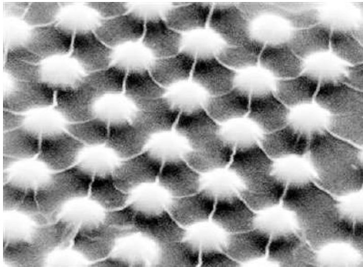
这张放大1万倍的图片显示，一个电子器件上雕刻出了高低不平的“山峰”和“山谷”，铺在上面的二硫化钼经过拉伸后，形成了一种拥有可变能隙的人工晶体。
