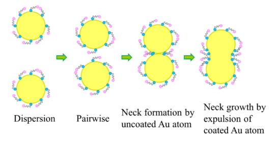
水溶液中巯基羧酸修饰的金纳米颗粒的融合生长机制示意图
