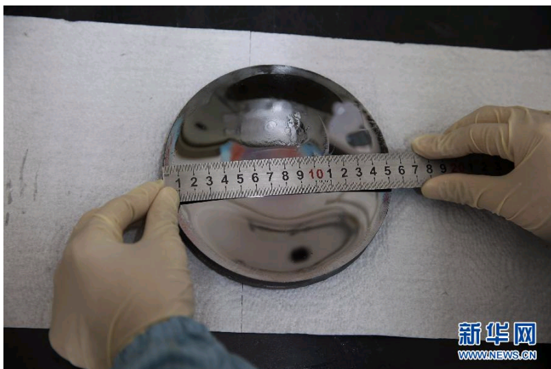
科研人员在测量6英寸碳化硅单晶衬底的尺寸（12月9日摄）。
