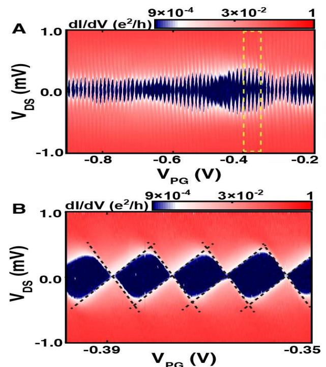
$\text{Bi}_2\text{Te}_3$ 纳米薄片单电子晶体管器件的电子输运特性，其中A为微分电导随栅压和源漏偏压的变化图（器图
