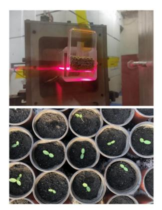
近日,原子能院与沈阳农业大学紧密合作,在100MeV强流质子回旋加速器上首次开展农作物种子辐照育 种实验研究,这也是国内首次利用中能质子束进行甜瓜种子辐照育种实验。此次利用中能质子束技术辐照诱 变甜瓜种子,期望能够构建基于质子束诱变技术的甜瓜育种新方法和新途径,创新甜瓜种质新资源。
