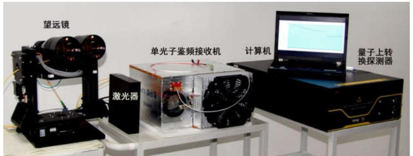
窦贤康课题组夏海云副教授与潘建伟课题组张强教授参展的“微脉冲多普勒测风激光雷达”获得特别嘉许金奖。该技术通过提高量子效率（光电转化效率）和光学集成度（系统率），综合抑制探测噪声，实现了昼夜连续观测、轻小防振、低功耗、常温环境下运行保偏结构的激光雷达系统，适合在机载、舰载、星载等平台的恶劣环境下运行，可广泛应用于保、气象、机场风切变预警、风力发电等领域，被新华网、解放军报等国内外新闻媒体报道。
