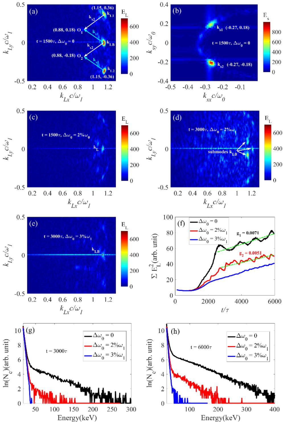
不同带宽的多光束激发的SRS共用模式。(a) - (b) 没有带宽的两束光激发的SRS相图, 可见多个很强的共用模式。(c) - (d) 带宽为2%的多色光激发的不稳定相图, 可见强度被削弱。(e) 带宽为3%的多色光激发的不稳定相图, 未见明显的不稳定激发。(f) - (h) 说明多色光在非线性阶段亦有明显的抑制作用。
