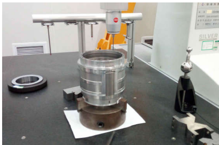
三坐标检测主轴的尺寸与形位精度
