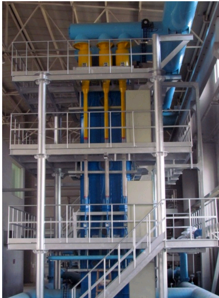
超临界循环流化床八边形炉膛冷态试验台调试成功
