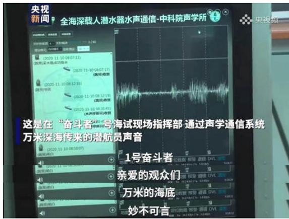
由声学多普勒测速仪和定位声纳及惯性导航等设备相集成的组合导航系统为“奋斗者”号的巡航作业提供了高精度的水下定位导航。在11月16日的下潜作业中，借助组合导航系统和声纳设备，“奋斗者”号潜航员仅用了半小时便成功取回了此前布放在万米海底的3个水下取样器，成功实现“海底捞针”，并通过水声通信机将取样画面回传至母船。
