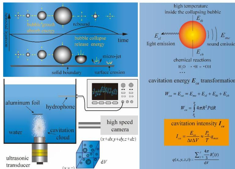
空化强度定义及测量方法示意图 (图/中科院声学所)
