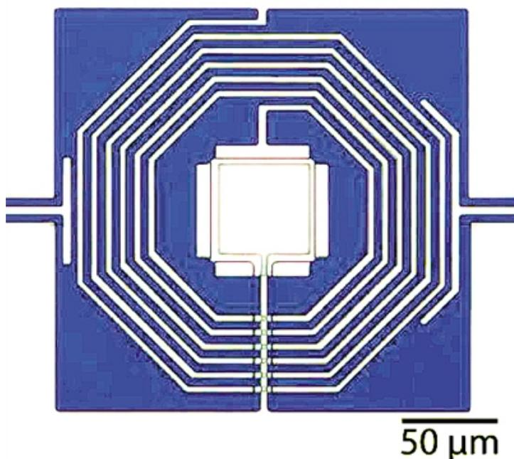
理论上, 量子噪声是所有物体运动所固有的, 施瓦伯和同事设计了一种装置, 能观察并控制量子噪声。这种微米级的装置由柔性铝片和上面的一层硅基质构成。
